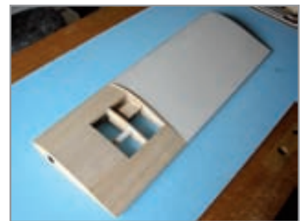
Abb. 7: Rohbau mit Depron
