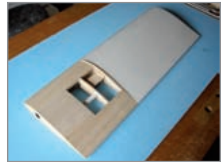
Abb. 7: Rohbau mit Depron
